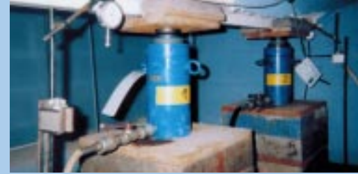
Vérins hydrauliques pour reprendre la flexion
