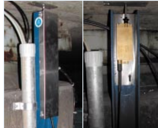
Extensomètre avec et sans capot de protection.
