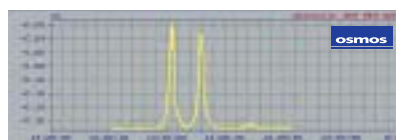
Réponse des cordes optiques sous l'effet du trafic
