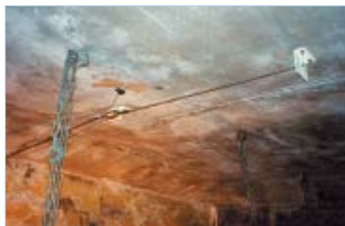
Extensomètre optique sur profil en travers
