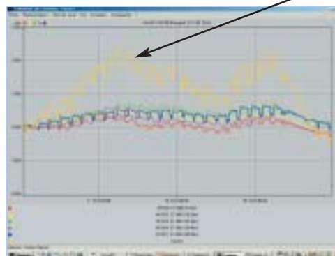
La somme de plusieurs cordes optiques montées en série peut être ainsi affichée comme variation d'allongement totale d'un grand linéaire de structure, par exemple ici en jaune
