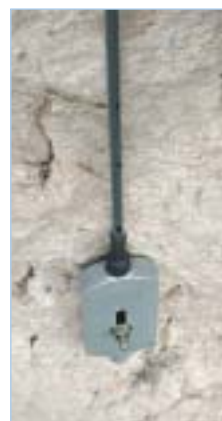
Corde optique gainée flexible acier - Fixation profonde par scellement chimique
