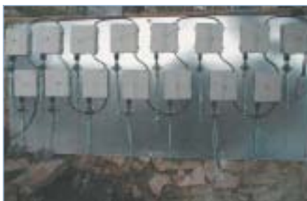
Batterie de 15 X-Triggers reliés aux 3 harpes
