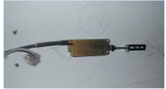
Fissuromètre optique et sonde thermique
