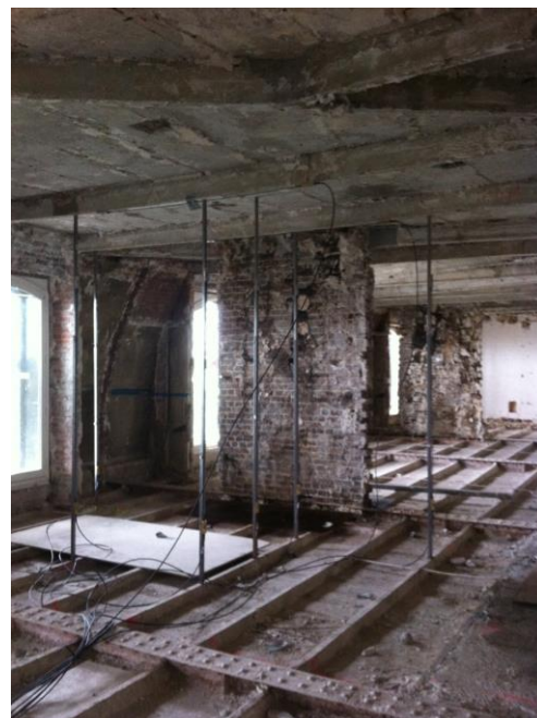
Cordes Optiques installées sur mât pour mesurer les flèches sous planchers
